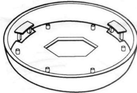
6. Den Kragen wieder durch eine Drehung im Uhrzeigersinn am Montagering befestigen.
