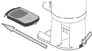
**2** Füllstutzen entnehmen und unter fließendem Wasser mit Reinigungsbürste säubern. Dispenser innen ebenfalls mit Bürste reinigen und mit heißem Wasser durchspülen. **Füllstutzen nicht in Wasser eintauchen!** **Füllstutzen ist nicht spülmaschinengeeignet!**
