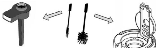
**5** Rändelschraube lösen, nicht abdrehen und Schutz nach vorn herausziehen. Danach mit Tuch oder in der Spülmaschine reinigen.
