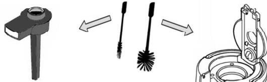
**3** Reinigungstablette einwerfen und Füllstutzen wieder einsetzen. Anschließend unter der Maschine mit heißem Wasser befüllen und 30 Minuten einwirken lassen. *(Gleicher Vorgang wie Kaffeebrühen nur ohne Filter und Kaffee)*
